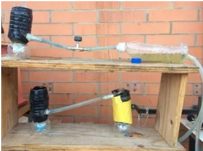
Figura 1: Protótipos de reator anaeróbio em funcionamento
