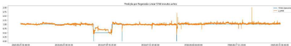
Figura 12 – Predição por regressão linear 5760 minutos antes da falha
